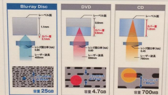
レーザー光の波長とNAとカバー層の厚みの比較図
